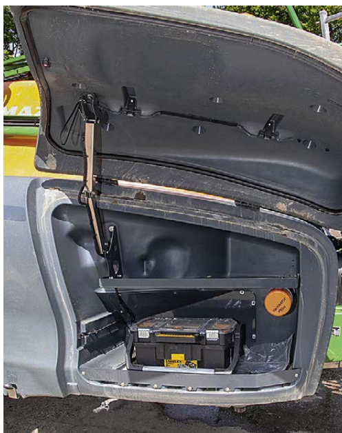
Абсолютно герметичный, чрезвычайно просторный отсек для хранения мелочевки может оснащаться опциональной подсветкой — пять с плюсом!
